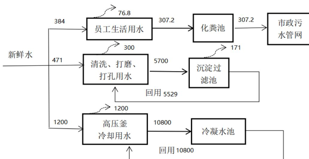
图 2-2 建设项目排水平衡图（单位：t/a）
