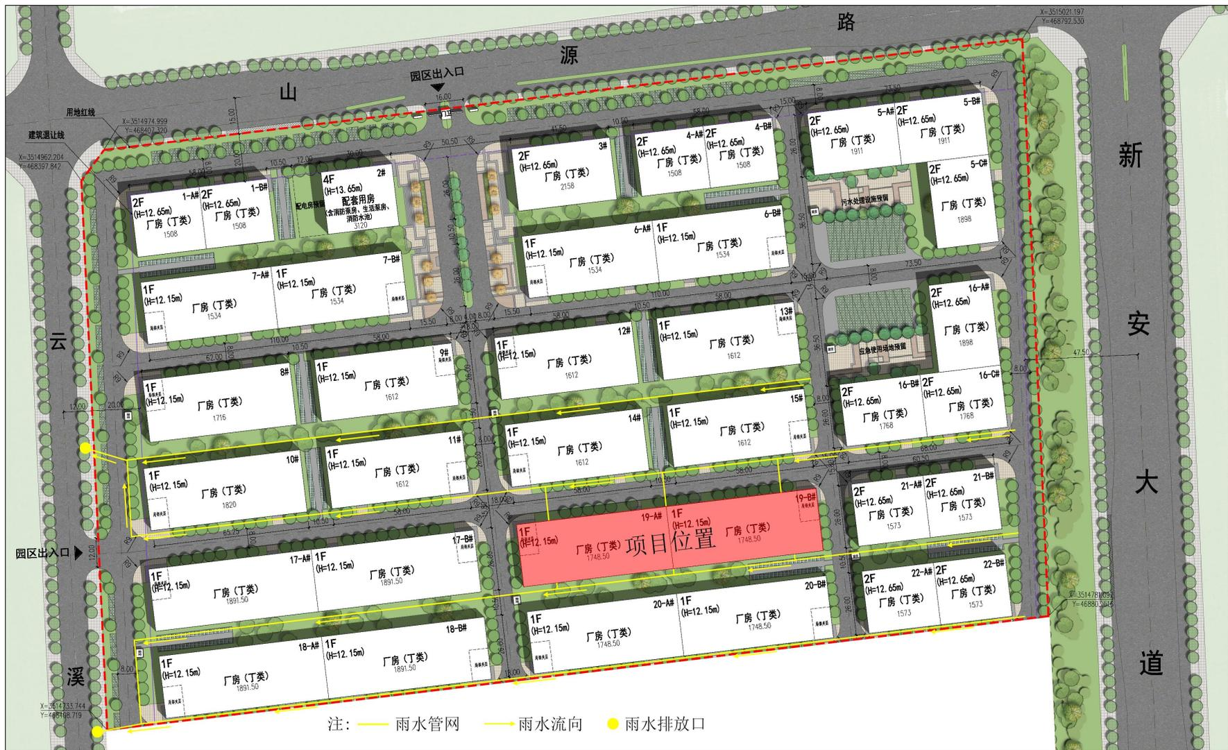
图 8 项目雨水管网图
