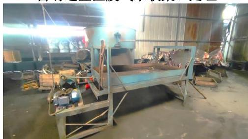
人工造型区混砂废气未收集、处理
