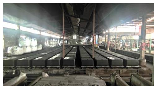
浇注工序废气未收集、处理
