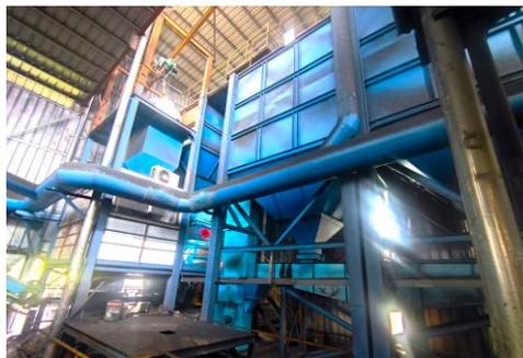
砂处理系统及废气收集管道
