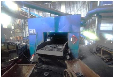
落砂机及废气收集管道
