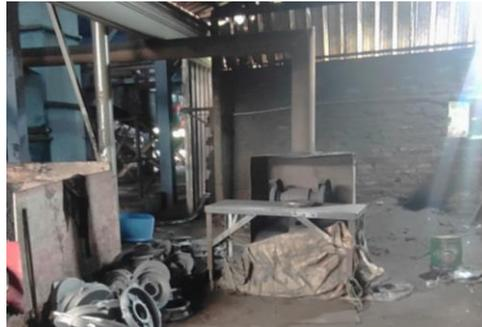
砂轮机打磨台及废气收集管道
