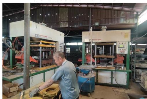
制（射）芯工序废气未收集、处理
