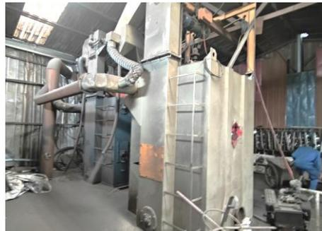
抛丸机（背面）及废气收集管道
