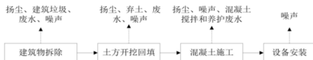
图2-1 建筑物工程施工过程和产污节点图
