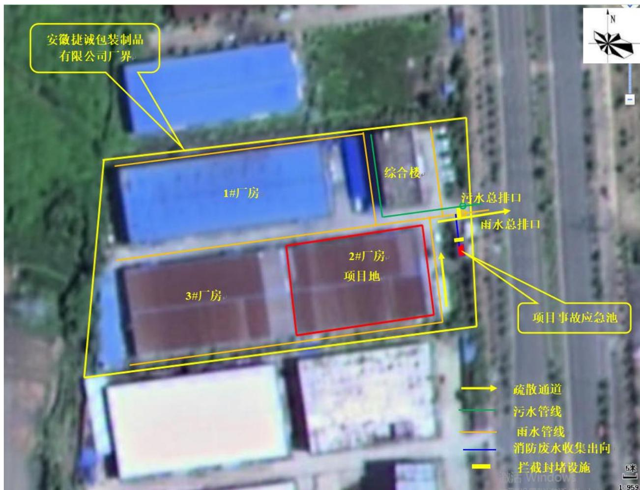
图 6-1 事故废水控制封堵图及应急疏散通道系统图
