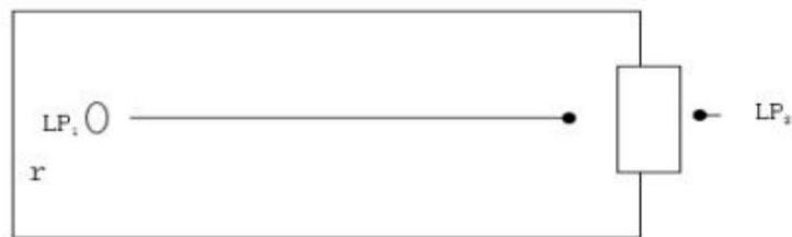
图 4-2 室内声源等效为室外声源图例
